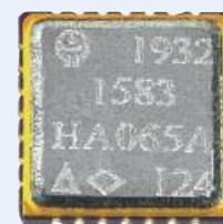
Фотография микросхем 12-разрядных АЦП и ЦАП в металлокерамических безвыводных корпусах
