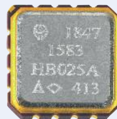
Фотография микросхем 12-разрядных АЦП и ЦАП в металлокерамических безвыводных корпусах
